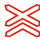
P-11 a Situación de un paso a nivel sin barreras de más de una vía férrea
