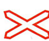
P-11 Situación de paso a nivel sin barreras
